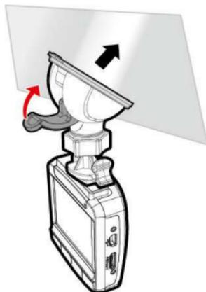
3. Halten Sie die Basis sicher an die Windschutzscheibe gedrückt; klappen Sie den Riegel zur Befestigung der Fahrzeughalterung an der Windschutzscheibe hinunter. Vergewissern Sie sich, dass die Basis sicher befestigt ist.
