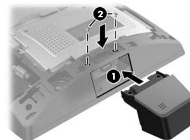
4. Allineare le linguette del coperchio posteriore della testa del display con gli alloggiamenti sulla testa del display. Posizionare il coperchio sulla testa del display, quindi farlo scorrere verso il basso per farlo scattare in posizione.
