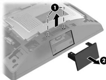
3. Inserire il connettore USB del lettore di impronte digitali nella porta USB laterale ①, quindi fissare il modulo mediante le due viti rimosse precedentemente ②.
