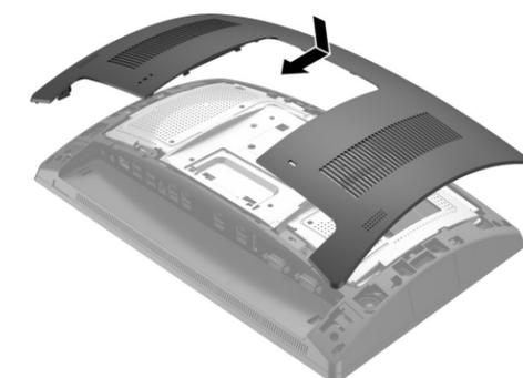
4. Rimuovere il coperchio dal braccio per display CFD tirando indietro prima la parte superiore del coperchio ❶ poi la parte inferiore. Inserire il connettore USB del display CFD nella porta USB ❷, quindi fissarlo mediante la vite fornita ❸. Rimettere in posizione il coperchio del braccio ❹ facendo scorrere prima la parte superiore poi la parte inferiore del coperchio sul braccio.
