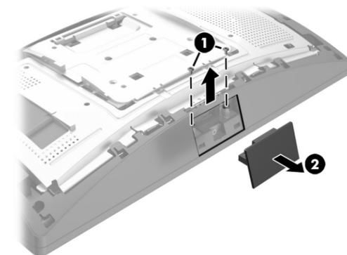
3. Allineare le linguette sul coperchio posteriore della parte superiore del display con gli alloggiamenti sulla parte superiore del display. Posizionare il coperchio sulla parte superiore del display, quindi far scorrere il coperchio verso il basso per farlo scattare in posizione.
