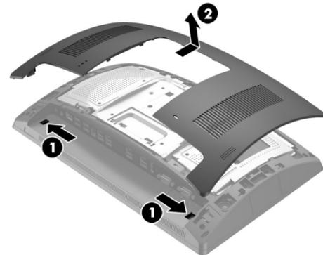
2. Remova os dois parafusos que prendem a tampa da porta superior **1** e, em seguida, puxe a tampa da porta para fora do monitor **2**.
