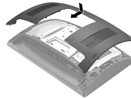
4. Remova a tampa do braço do CFD puxando a parte superior da tampa **1** e, em seguida, a parte inferior da tampa. Insira o conector USB do CFD na porta USB **2** e, em seguida, prenda o CFD com o parafuso fornecido **3**. Substitua a tampa do braço **4** encaixando a parte superior da tampa no braço e, em seguida, a parte inferior da tampa.
