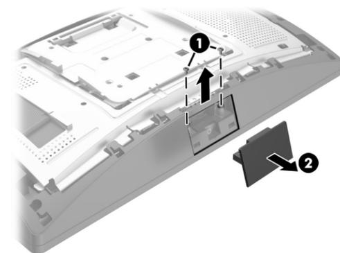
3. Alinhe as linguetas da tampa traseira do monitor com os encaixes no monitor. Coloque a tampa no monitor e, em seguida, deslize a tampa para baixo até que se encaixe no lugar.
