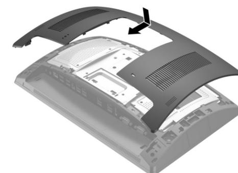
4. Lepaskan penutup dari lengan CFD dengan menarik ke belakang bagian atas penutup ❶ dan kemudian bagian bawah penutup. Masukkan konektor USB di CFD ke port USB ❷, dan kemudian kencangkan CFD dengan sekrup yang tersedia ❸. Pasang penutup lengan ❹ dengan mengunci bagian atas penutup ke bagian lengan dan kemudian bagian bawah penutup.
