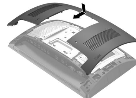
4. Extraiga la cubierta del brazo de la CFD tirando hacia atrás la parte superior de la cubierta **1** y luego de la parte inferior. Inserte el conector USB de la CFD en el puerto USB **2** y luego fije la CFD con el tornillo suministrado **3**. Vuelva a colocar la cubierta del brazo **4** encajando la parte superior de la cubierta sobre el brazo y luego la parte inferior de la cubierta.
