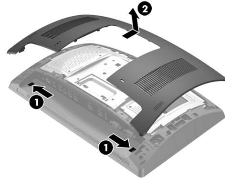
2. Extraiga los dos tornillos que sujetan la cubierta del puerto superior **1** y sepárela de la parte principal del monitor **2**.
