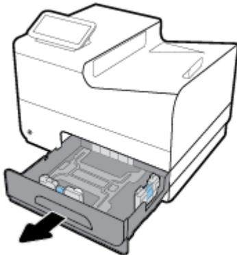
2. Legen Sie Umschläge mit der oberen Kante des Umschlags in Richtung Vorderseite des Faches ein.
