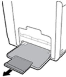
3. Legen Sie Umschläge in Fach 1 mit der Vorderseite nach unten und der oberen Kante des Umschlags in Richtung Vorderseite des Druckers ein.
