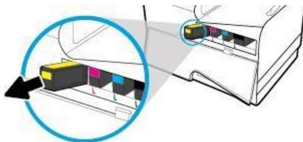
4. Non toccare i contatti metallici sulla cartuccia. La presenza di impronte sui contatti può causare errori di connessione.
