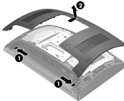
2. Entfernen Sie die beiden Schrauben, die die Seitenabdeckung des Anschlusses sichern **1**, und ziehen Sie dann die Abdeckung des Anschlusses vom Displaykopf ab **2**.
