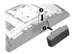
4. ディスプレイ本体の背面カバーのタブとディスプレイ本体のスロットの位置を合わせます。カバーをディスプレイ本体の上に置き、正しい位置にロックされるまでカバーをディスプレイの下部方向にスライドさせます。
