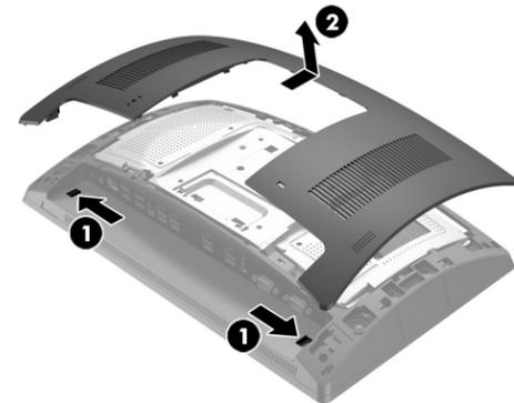
2. Entfernen Sie die zwei Schrauben, die die obere Anschlussabdeckung befestigen **1**, und schieben Sie die Abdeckung dann weg vom Displaykopf **2**.
