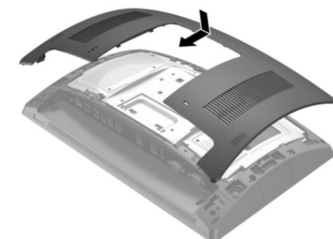
4. Entfernen Sie die Abdeckung vom CFD-Arm, indem Sie den oberen Teil der Abdeckung **1** und dann die Unterseite der Abdeckung zurückziehen. Stecken Sie den USB-Stecker auf dem CFD in den USB-Anschluss **2** und sichern Sie das CFD dann mit der Schraube, die im Lieferumfang enthalten ist **3**. Setzen Sie die Armabdeckung auf **4**, indem Sie die Oberseite der Abdeckung auf dem Arm und dann auf der Unterseite der Abdeckung einrasten lassen.
