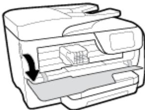
3. Si el carro de impresión no está obstruido, desplácelo totalmente al lado derecho de la impresora y extraiga el papel atascado.
