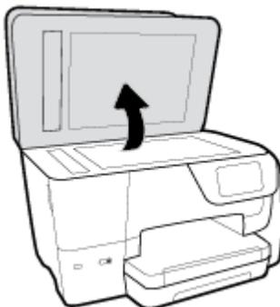
2. Cargue el original con la cara de impresión hacia abajo, como se muestra en la ilustración.
