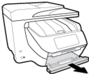
3. Entfernen Sie das eingeklemmte Papier.
