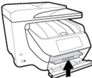
11. Klappen Sie die Duplex-Klappe hoch, schieben Sie diese nach hinten und schließen Sie die Duplex-Klappe.
