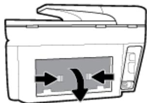
3. Entfernen Sie das eingeklemmte Papier.
