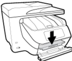
9. Entfernen Sie das eingeklemmte Papier.
