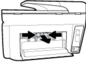
5. Entfernen Sie das eingeklemmte Papier.
