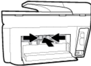
7. Schließen Sie die hintere Zugangsklappe.
