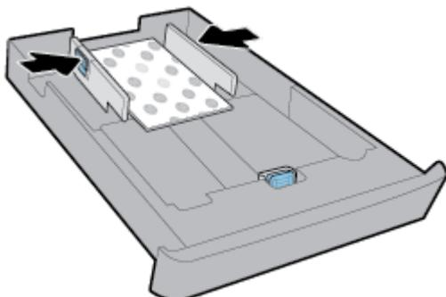
5. Certifique-se de que a pilha de papel não exceda a marcação de altura da pilha do lado da bandeja.
