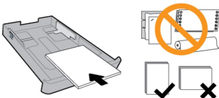
Certifique-se de que a pilha de papel esteja alinhada com as linhas apropriadas de tamanho do papel, na frente da bandeja. Além disso, verifique se a pilha de papel não excede a altura da pilha marcada na borda direita da bandeja.
