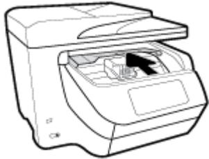
2. Abra a tampa interna levantando-a e movendo-a em direção a você.
