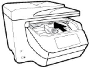
2. Se o carro de impressão não estiver obstruído, mova-o para a extrema-direita da impressora e retire o papel atolado.
