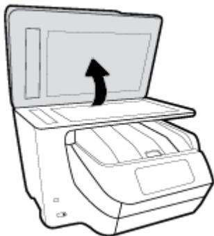
2. Limpe o vidro e a parte posterior da tampa do scanner utilizando um pano macio e sem fiapos levemente umedecido com um produto neutro de limpeza de vidros.
