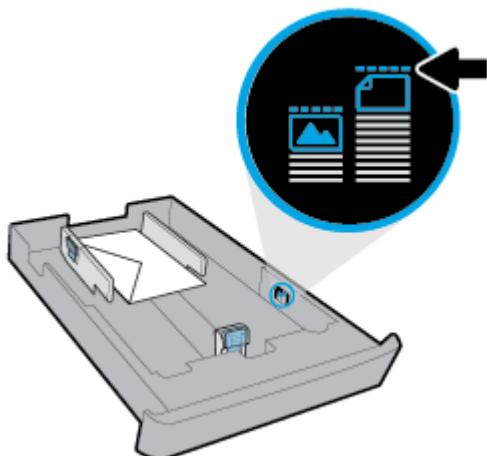
6. Отрегулируйте положение направляющих длины бумаги. Они должны касаться края стопки конвертов.
