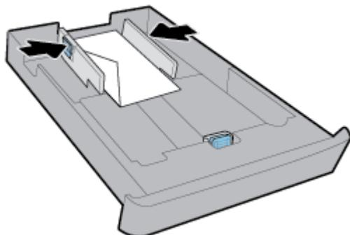
5. Высота стопки конвертов не должна превышать отметку на стенке лотка.
