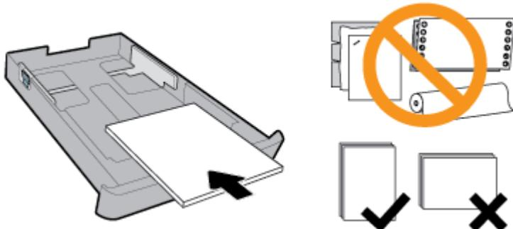
Стопка бумаги должна располагаться в соответствии с отметками нужного формата на передней части лотка. Кроме того, ее высота не должна превышать отметку на правой стенке лотка.
