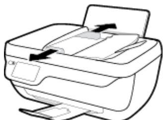
3. Vložte předlohu do podavače dokumentů potiskovanou stranou nahoru a horní hranou napřed.
