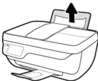
2. Ujistěte se, že dráhu papíru neblokují žádné cizí předměty, a znova papír vložte.
