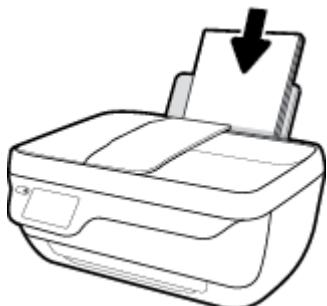
2. Vložte předlohu tiskovou stranou nahoru do podavače dokumentů nebo ji vložte tiskovou stranou dolů do pravého předního rohu skleněné plochy skeneru.
