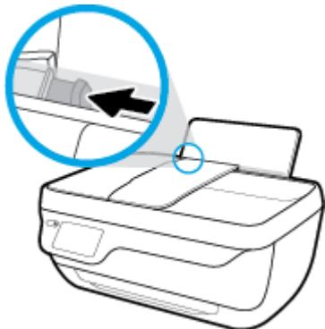
3. Vložte balík papírů do vstupního zásobníku kratší stranou dolů a tiskovou stranou nahoru. Zasuňte balík papírů na doraz.
