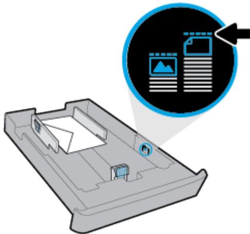
6. Schieben Sie die Papierlängsführung bündig an die Kante des Umschlagstapels heran.
