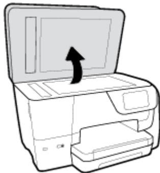
2. Reinigen Sie das Scannerglas und die Unterseite der Abdeckung mit einem sauberen, fusselfreien Tuch, das mit einem milden Glasreinigungsmittel angefeuchtet wurde.
