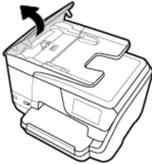
Dadurch erhalten Sie einfachen Zugang zu den Walzen (1) und zum Trennsteg (2).
