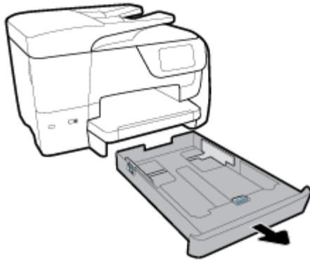
2. Überprüfen Sie den Bereich des Zufuhrfachs unterhalb des Druckers. Eingeklemmtes Papier entfernt.
