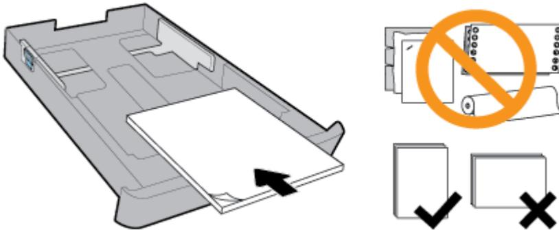
Stellen Sie sicher, dass der Papierstapel den Papierformat-Linien an der Vorderseite des Faches entsprechend ausgerichtet ist. Stellen Sie darüber hinaus sicher, dass der Papierstapel die Höhenmarkierung am rechten Rand des Faches nicht übersteigt.
