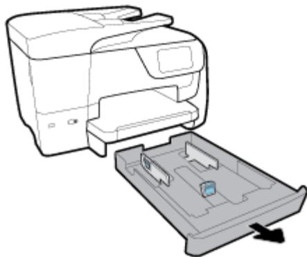
2. Schieben Sie die Papierführungen innerhalb des Faches bis zum Anschlag nach außen.
