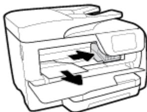
4. Schieben Sie den Schlitten bei Bedarf bis zum Anschlag nach links und entfernen Sie gestautes Papier oder zerrissene Papierstücke.
