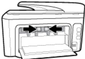
4. Entfernen Sie das eingeklemmte Papier.
