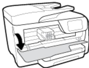
3. Drücken Sie auf die Vorderseite der Patrone, um sie freizugeben, und nehmen Sie diese anschließend aus der Halterung.
