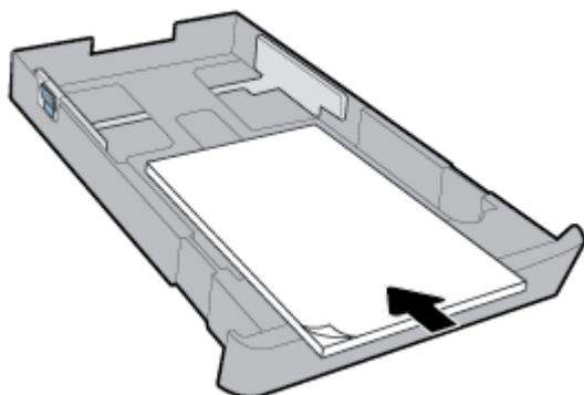
确保纸叠与纸盒前面合适的纸张大小线条对齐。此外，确保纸叠不超过纸盒右边缘上的堆叠高度标记。
