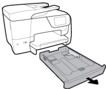
2. 检查打印机下面的进纸盒区域。取出卡住的纸。
