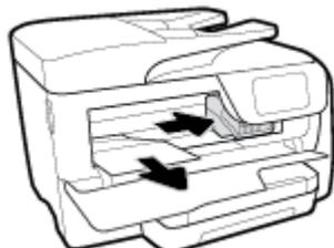
4. 如必要，将托架移动到打印机的最左侧，并取出任何卡纸或皱纸。
