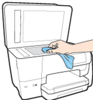
**注意:** 只能使用玻璃清洁剂清洁扫描仪玻璃板。避免使用包含研磨剂、丙酮、苯和四氯化碳的清洁剂，所有这些物质都会损坏扫描仪玻璃板。避免使用异丙醇，因为它会在扫描仪玻璃板上留下条纹。
