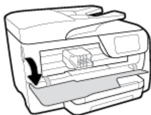
3. 如果墨盒托架未被堵塞，则将墨盒托架移动到打印机的最右侧并取出卡住的纸。
