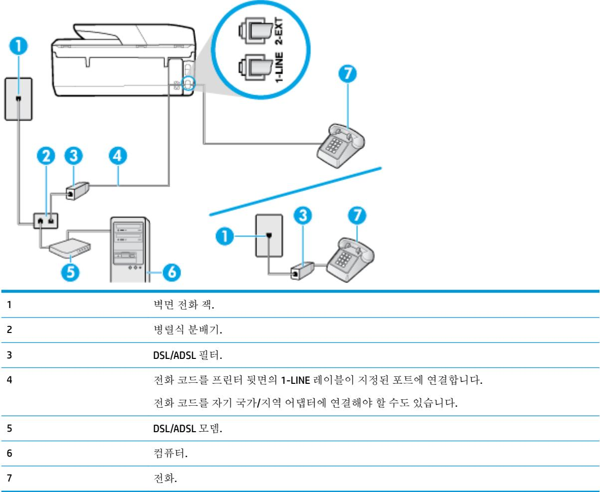
**참고:** 병렬 분배기를 구입할 필요가 있습니다. 병렬 분배기 앞면에는 RJ-11 포트가 하나 있으며 뒷면에는 두 개가 있습니다. 2라인 전화 분배기, 직렬 분배기, 앞면에 RJ-11포트 두 개가 있고 뒷면에 플러그 하나가 있는 병렬 분배기는 사용하지 마십시오.
