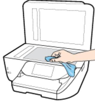
**تنبيه:** لا تستخدم سوى منظف الزجاجات لتنظيف سطح الماسحة الضوئية الزجاجي. تجنب استخدام المنظفات المحتوية على المواد الحادشة أو الأستيون أو البنزين أو رابع كلوريد الكربون، لأن هذه المواد تضر زجاج الماسحة الضوئية. تجنب استخدام كحول الأيزوبروبيل لأنه قد يترك خطوطًا على الزجاج.
