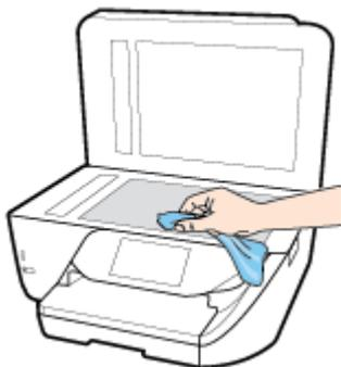
**⚠ ATTENTION :** Pour nettoyer la vitre du scanner, utilisez exclusivement du produit de nettoyage des vitres. Évitez les produits nettoyants contenant des abrasifs, de l'acétone, du benzène ou du tétrachlorure de carbone, car ceux-ci risquent d'endommager la vitre du scanner. Évitez l'alcool isopropylique, car il peut laisser des traces sur la vitre du scanner.
