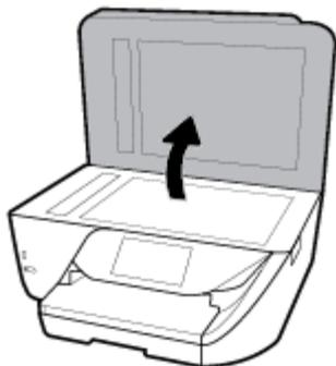
2. Nettoyez la vitre du scanner et la partie inférieure du capot au moyen d'un chiffon doux non pelucheux sur lequel a été vaporisé un produit doux de nettoyage pour vitres.
