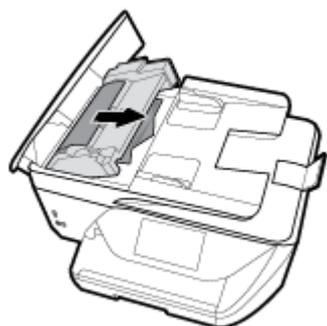
4. Refermez le capot du bac d'alimentation automatique en appuyant dessus fermement jusqu'à ce qu'il se mette en place.
