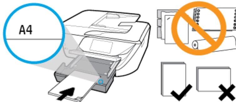
Stellen Sie sicher, dass das Papier an den entsprechenden Papierformatlinien unten im Zufuhrfach ausgerichtet ist und der Stapel die seitliche Markierung für die Stapelhöhe nicht überschreitet.
