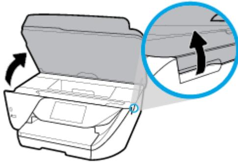
3. Drücken Sie auf die Vorderseite der Patrone, um sie freizugeben, und nehmen Sie diese anschließend aus der Halterung.
