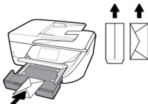
Stellen Sie sicher, dass das Papier an den entsprechenden Papierformatlinien unten im Zufuhrfach ausgerichtet ist und der Stapel die seitliche Markierung für die Stapelhöhe nicht überschreitet.
