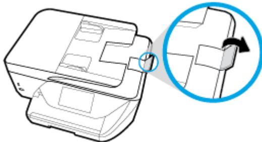
2. Legen Sie das Original mit der bedruckten Seite nach oben in den Vorlageneinzug ein.
