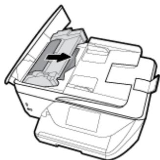
4. Schließen Sie die Abdeckung des Vorlageneinzugs, indem Sie diese bis zum Einrasten nach unten drücken.
