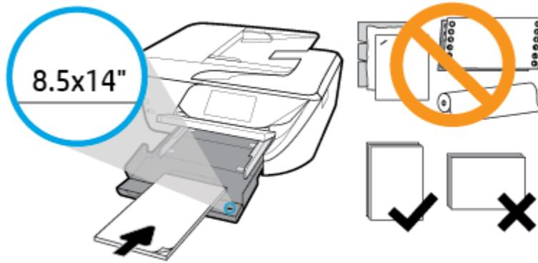
Vergewissern Sie sich, dass der Papierstapel an den entsprechenden Papierformatlinien an der Vorderseite des Fachs ausgerichtet ist. Stellen Sie darüber hinaus sicher, dass der Papierstapel die Markierung für die Maximalhöhe des Stapels an der Kante des Fachs nicht überschreitet.
