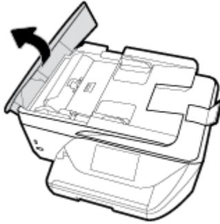
Dadurch erhalten Sie einfachen Zugang zu den Walzen (1) und zum Trennsteg (2).
