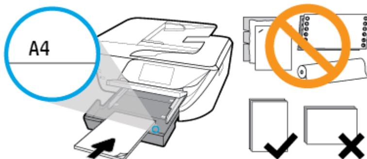
Verifique se a pilha de papel está alinhada às linhas de tamanho de papel apropriadas na parte inferior da bandeja de entrada e se não excede a altura da pilha marcada na lateral.
