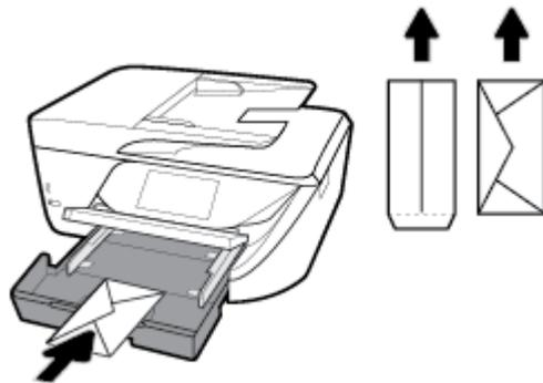
Verifique se a pilha de papel está alinhada às linhas de tamanho de papel apropriadas na parte inferior da bandeja de entrada e se não excede a altura da pilha marcada na lateral.
