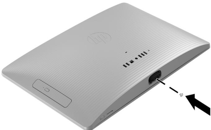
5. Alinee el soporte con los dos orificios en la parte inferior del equipo y, a continuación, apriete los dos tornillos de sujeción.
