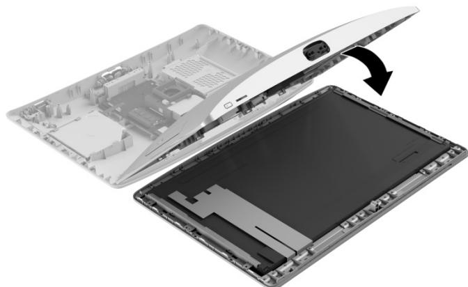
3. Alinee la cubierta con el equipo y presione hacia abajo hasta que encaje en su posición.
