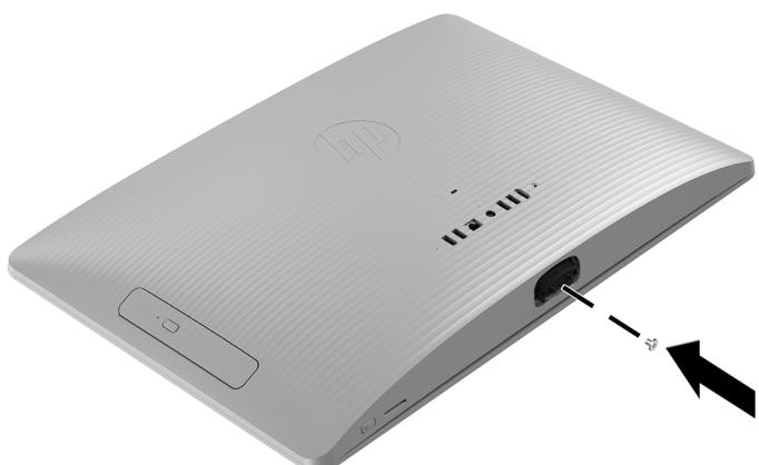
5. Alignez le socle sur les trous sous l'ordinateur, puis serrez les deux vis imperdables.
