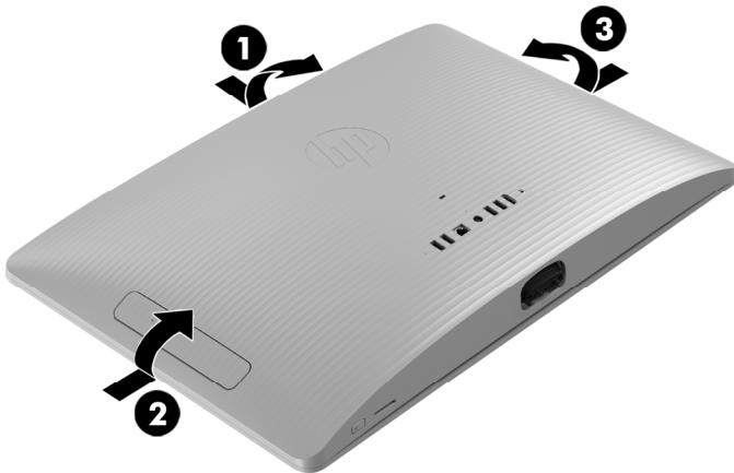
6. Afin de ne pas endommager le câble reliant la carte mère au capot arrière, soulevez délicatement le bord inférieur du capot, puis faites pivoter le capot jusqu'à ce qu'il repose à l'envers près de l'écran.
