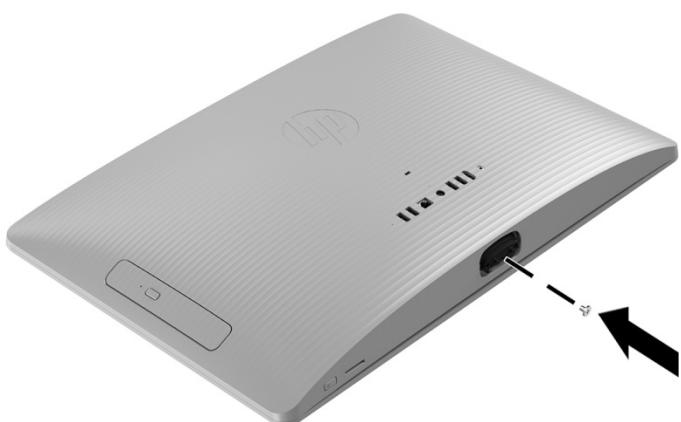
2. Introduzca la carcasa de la unidad en el equipo (1), vuelva a colocar el tornillo Phillips (2) y, a continuación, conecte el cable de la unidad en la unidad (3).
