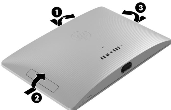
6. Para evitar dañar el cable que conecta la placa del sistema a la cubierta posterior, levante con cuidado el borde inferior de la cubierta y luego gire la cubierta hasta que quede de pie al lado del conjunto de la pantalla.
