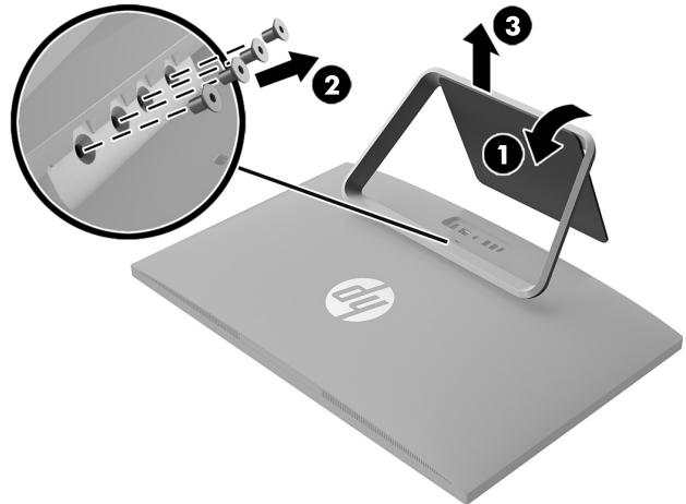
4. Pour retirer le capot arrière, retirez les deux cache-vis (1) et les deux vis cruciformes (2) sous le capot. Soulevez le capot et placez-le à l'envers à côté de l'ordinateur (3). Le câble de la webcam relie la webcam installée sur le capot arrière et la carte mère.
