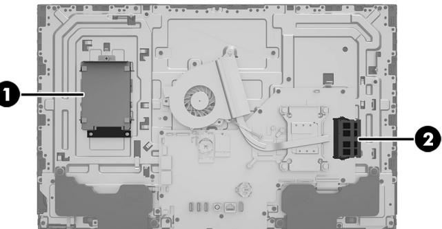
7. Séparez les deux loquets de retenue (1) jusqu'à ce que le module mémoire soit incliné vers le haut selon un angle de 45 degrés. Retirez le module mémoire (2). Suivez la même procédure pour retirer les deux modules mémoire.
