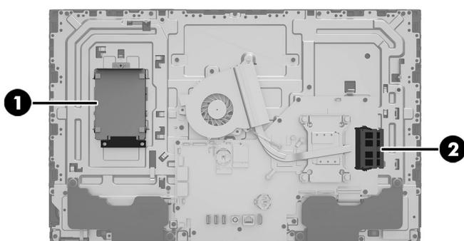
6. Retirez la vis cruciforme qui maintient le bloc de disque (1), tirez sur le câble dans la direction opposée au disque dur (2), puis retirez le bloc de disque de l'ordinateur (3).
