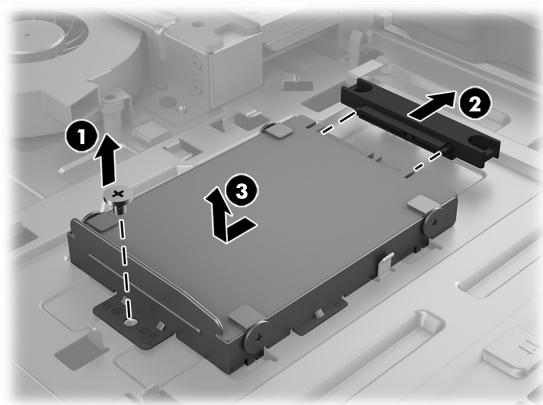
7. Pour extraire le disque dur de son bloc, retirez les quatre vis cruciformes situées sur les côtés du bloc de disque (1), puis faites glisser le disque dur pour l'extraire de son bloc (2).
