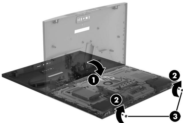
2. Insérez le bloc de disque dans l'ordinateur, puis faites-le glisser jusqu'à ce qu'il s'emboîte (1). Branchez le câble sur le disque dur (2), puis remettez la vis cruciforme (3).
