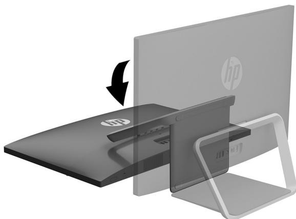
3. Pour retirer le socle, faites-le pivoter vers le haut (1), retirez les quatre vis à tête hexagonale (2), puis soulevez le socle vers le haut pour le retirer de l'ordinateur (3).
