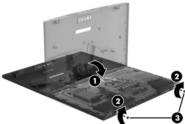
2. Inserte la carcasa de la unidad en el equipo y deslice la unidad hasta que encaje en su lugar (1). Fije el cable a la unidad (2) y, posteriormente, vuelva a colocar el tornillo Phillips (3).
