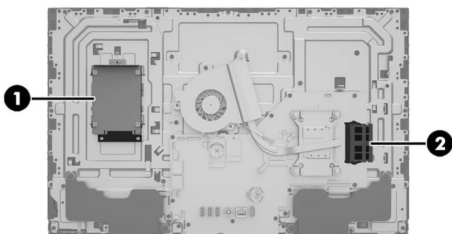
6. Extraiga el tornillo Phillips que fija la carcasa de la unidad (1), desconecte el cable de la unidad de disco duro (2) y, a continuación, extraiga la carcasa de la unidad del equipo (3).
