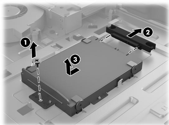
7. Para retirar una unidad de la carcasa, extraiga los cuatro tornillos Phillips situados en los laterales de la carcasa (1) y deslice la unidad fuera de su carcasa (2).
