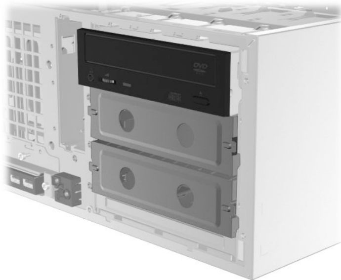
Рисунок 3-9 Встановлення пристрою для читання оптичних дисків
