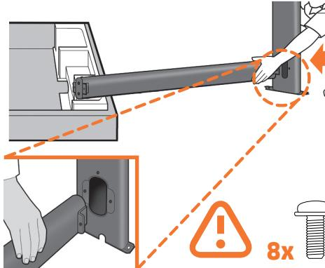
Understøt den ene ende af krydsafstivningen på stativkassen, **og fastør** et ben til det andet med to skruer **på ydersiden** og derefter to på indersiden af benet. Tilspænd ikke skruerne helt endnu. Fastør det andet ben på samme måde. Tilspænd nu skruerne helt **på ydersiden** af benene, efterfulgt af skruer **på indersiden**.
