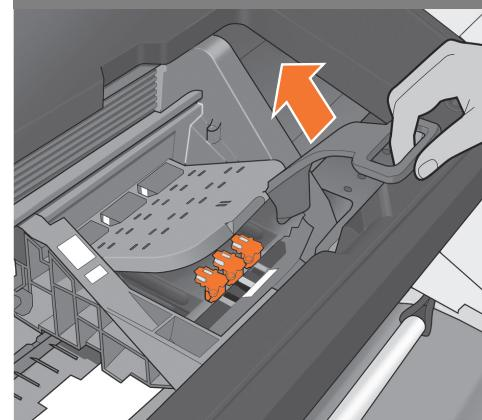
Løft håndtaget op for at åbne dækslet til printhovedet. Frontpanelet beder dig om at udføre næste trin: At fjerne printhovederne. Tryk ikke på OK, før du har fjernet alle de orange opsætningsprinthoveder.
