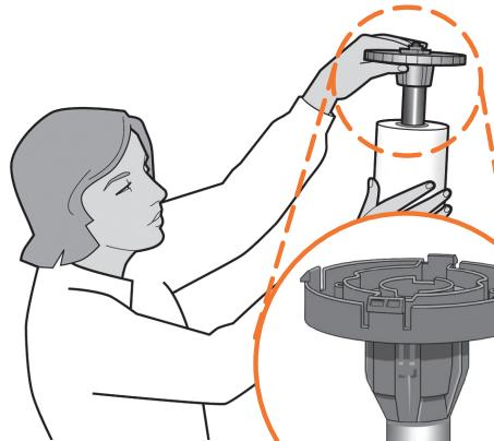
**Fjern den blå aftagelige stopper på spindlen, hvis den er sat på. Sæt rullen på spindlen, og sør for, at den vender rigtigt: Den forreste kant af papiret skal nå ind i enheden fra toppen af rullen. Sæt den aftagelige stopper på spindlen for at holde rullen på plads.**
