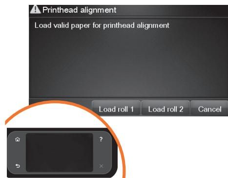
**DA** Når kontrollen af printhovederne er afsluttet, er printeren klar til ilægning af papir til justering af printhoveder.
