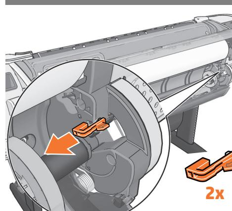
**lægning af papir for nedre rulle** Stil dig bag printeren og fjern de orange stoppere fra hver ende af spindlen. **Bemærk!** Det er ikke nødvendigt at montere den anden rulle for at tage printeren i brug. Hvis du foretrækker at montere den anden rulle senere, gå direkte videre til trin 77.
