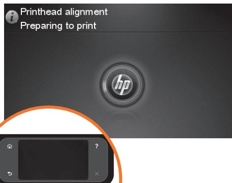
**DA** Printeren fortsætter med at justere printhovederne. Denne proces involverer udskrivning, og der er derfor behov for papir med en lige forkant. Bemærk! Justering af printhoveder kræver papir med en bredde på mindst 61 cm. Det anbefales at bruge rullepapir.
