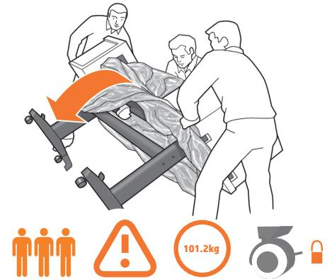
Hold printeren i endestykkerne og i midten bagtil, og rej den op, indtil den står på fodderne med alle fire hjul på gulvet. Printeren vejer 101,2 kg.
