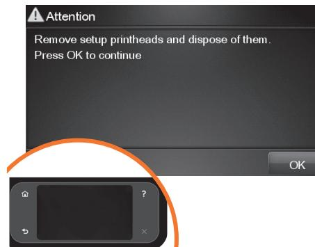
Opsætningsprinthovederne er udelukkende sat i for at forhindre, at der løber blæk ud under isætning af blækpatron. Frontpanelet beder dig nu om at fjerne opsætningsprinthovederne, hvorefter du skal trykke på OK.
