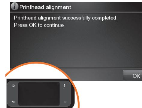
**DA** Frontpanelet viser en række meddelelser, der viser forløbet for justering af printhovedet. Du skal ikke foretage dig noget, før justeringen er afsluttet, når du får vist meddelelsen ned-enfor. Tryk på knappen OK.
