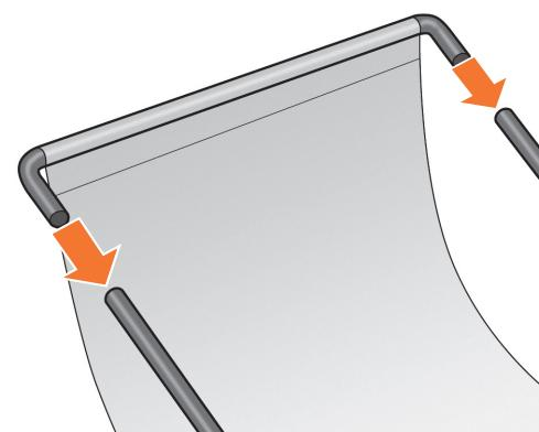
Sæt kurvens forreste rør på de to korte rør på hver fod.
