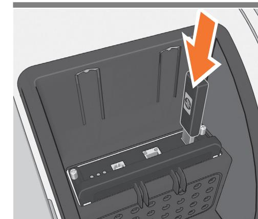
Hvis plastikposen i kassen indeholder et USB flash-drev, indeholder drevet den seneste firmware. Følg vejledningen i posen. Uden USB flash-drev kan dette trin springes over. \* **USB-drevet skal kun bruges i nogle printere.**
