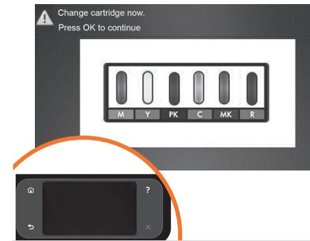
**DA** Når alle blækpatroner er korrekt på plads, skal printeren klargøre blæksystemet tilibrugtagning. Det sker, så snart du har trykket på knappen OK, eller efter en pause på 60 sekunder, hvis du ikke trykker på knappen. Når blæksystemet er klar, beder frontpanelet dig om at åbne vinduet.
