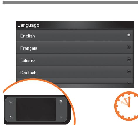
HP-logoet vises på frontpanelet. Vent et øjeblik. Du blive herefter bedt om at vælge sprog for printeren. Hvis USB flash-drev findes skal instruktionerne på panelet følges.
