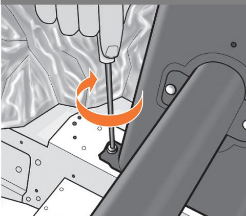
**DA** Når benene er korrekt placeret på printeren, fastgøres de med to skruer til hvert ben. Kontroller, at du har brugt i alt 20 skruer, og at de alle er tilspændt. Du skal have to skruer til overs, som medfølger som ekstra.
