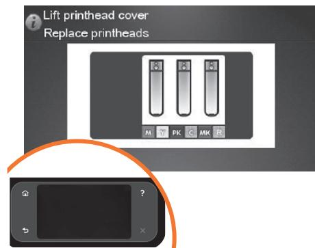
**DA** Tryk på OK på frontpanelet, når du har fjernet alle opsætningsprinthoveder. Frontpanelet beder dig nu om at installere de nye printhoveder.
