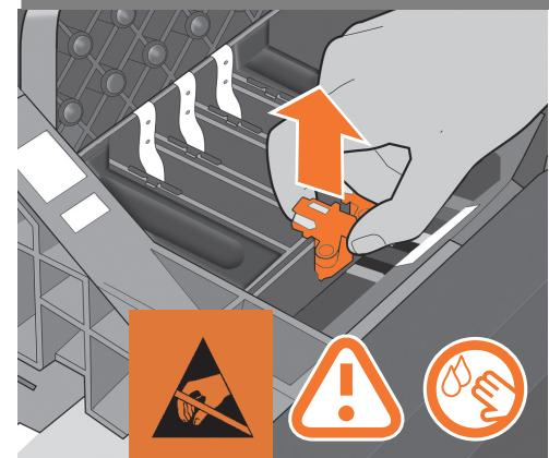
Fjern og kasser alle orange opsætningsprinthoveder. Du skal muligvis trække lidt til for at få hvert printhoved af. Opsætningsprinthovederne indeholder blæk, som kan løbe ud. Undgå at berøre ben, stifter eller kredsløb.
