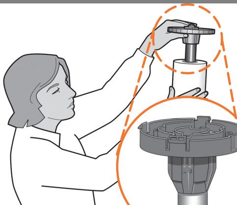
**DA** Fjern den blå aftagelige stopper på spindlen, hvis den er sat på. Sæt rullen på spindlen, og sørge for, at den vender rigtigt: Den forreste kant af papiret skal nå ind i enheden fra toppen af rullen. Sæt den aftagelige stopper på spindlen for at holde rullen på plads.
