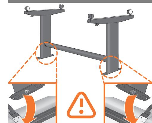
Placer nu langsomt og forsigtigt stativet på printeren, så de farvede knapper på benene passer ind i de tilsvarende huller på den. **Bemærk, at printerhuset vender på hovedet.**
