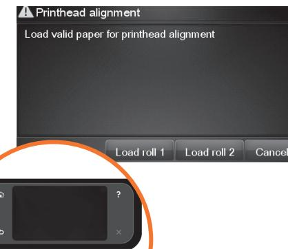
Når kontrollen af printhovederne er afsluttet, er printeren klar til tilægning af papir til justering af printhoveder.
