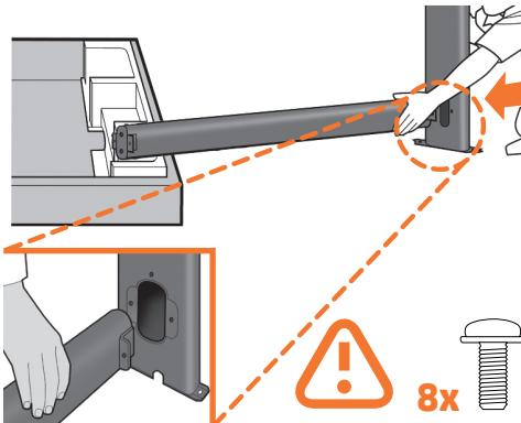
**DA** Understøt den ene ende af krydsafstivningen på stativkassen, og fastgør et ben til det andet med to skruer **på ydersiden** og dærefter to på indersiden af benet. Tilspænd ikke skruerne helt endnu. Fastgør det andet ben på samme måde. Tilspænd nu skruerne helt **på ydersiden** af benene, efterfulgt af skruer **på indersiden**.
