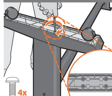
**Sæt en fod på hvert ben ved hjælp af fire skruer i hver fod. Sæt først alle skruerne løst på, og tilspænd dem efterfølgende.**
