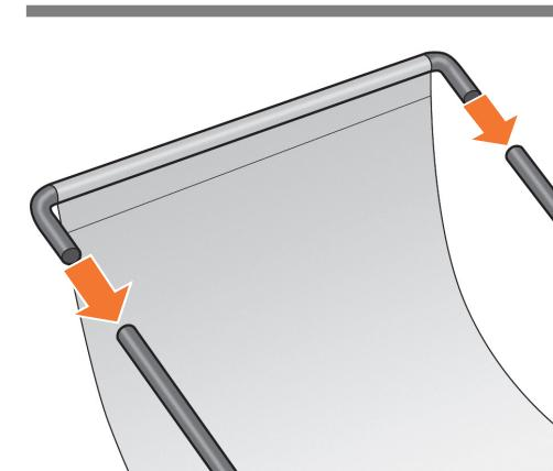
Sæt kurvens forreste rør på de to korte rør på hver fod.
