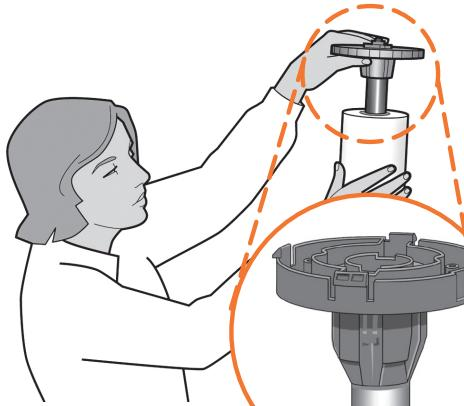
**DA** Fjern den blå aftagelige stopper på spindlen, hvis den er sat på. Sæt rullen på spindlen, og sørг for, at den vender rigtigt: Den forreste kant af papiret skal nå ind i enheden fra toppen af rullen. Sæt den aftagelige stopper på spindlen for at holde rullen på plads.
