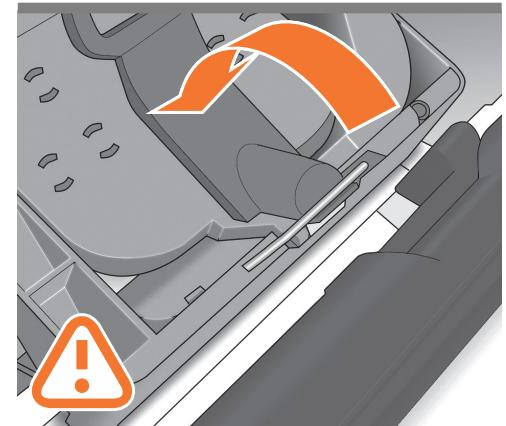
Skub håndtaget ned oven på printhoveddækslet. Printeren kontrollerer og klargør af nye printhoveder, hvilket kan tage 30 til 40 minutter, afhængig af printhovedernes tilstand og det omgivende miljø. **Luk dækslet.**
