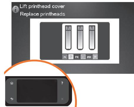
Tryk på OK på frontpanelet, når du har fjernet alle opsætningsprinthoveder. Frontpanelet beder dig nu om at installere de nye printhoveder.
