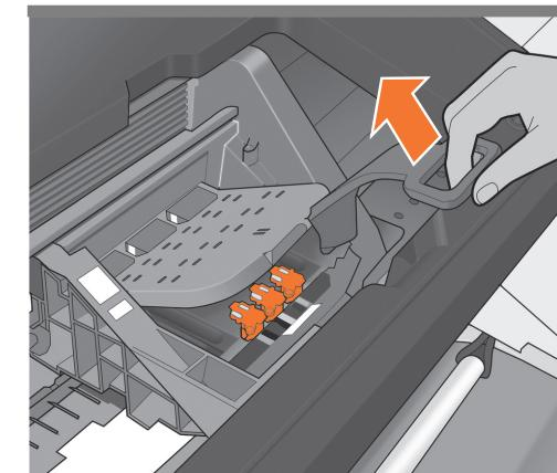
Løft håndtaget op for at åbne dækslet til printheadet. Frontpanelet beder dig om at udføre næste trin: At fjerne printheadene. Tryk ikke på OK, før du har fjernet alle de orange opsætningsprintheadene.
