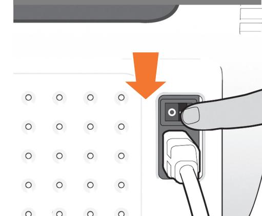
Tænd for strømmen på printeren ved hjælp af afbryderen lige over stikket. Fjern den plastfilm, der dækker vinduet, og den film, der dækker frontpanelet (LCD-display).
