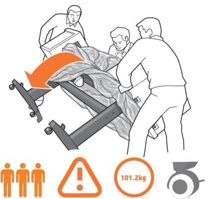
**Hold printeren i endestykkerne og i midten bagtil, og rejs den op, indtil den står på fødderne med alle fire hjul på gulvet. Printeren vejer 101,2 kg.**
