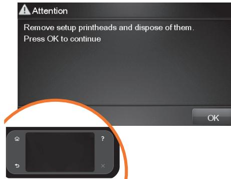
**DA** Opsætningsprinthovederne er udelukkende sat i for at forhindre, at der løber blæk ud under isætning af blækpatron. Frontpanelet beder dig nu om at fjerne opsætningsprinthovederne, hvorefter du skal trykke på OK.
