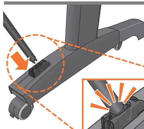
Sæt de to korte rør på printerens fodder, en Forrest på hver fod. Hvert rør skal klikke på plads.
