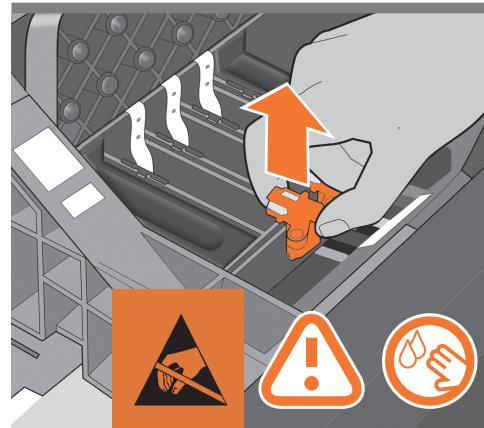
Fjern og kasser alle orange opsætningsprinthoveder. Du skal muligvis trække lidt til for at få hvert printhoved af. Opsætningsprinthovederne indeholder blæk, som kan løbe ud. Undgå at berøre ben, stifter eller kredsløb.
