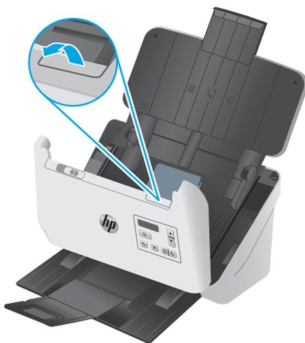
3. A l'arrière du chargeur de documents ouvert, utilisez un ongle pour appuyer sur la languette située sur la partie supérieure droite du capot du rouleau d'entraînement, puis poussez-la vers l'avant pour ouvrir le capot et exposer les rouleaux d'entraînement.
