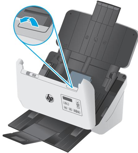
3. A l'arrière du bac d'alimentation ouvert, appuyez avec le bout de votre doigt sur l'onglet situé sur la partie supérieure droite du capot de protection des rouleaux d'entraînement, puis tirez-le vers l'avant afin d'ouvrir le capot et d'exposer les rouleaux d'entraînement.
