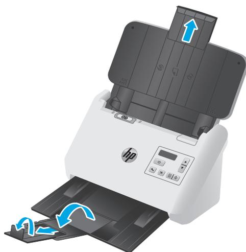
Per il vassoio di uscita, estrarre il vassoio dalla parte inferiore dello scanner, sollevare la prima estensione, far scorrere la seconda verso l'esterno, quindi ruotare la terza linguetta di 90 gradi.
