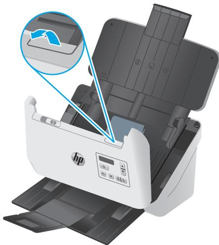
3. Nella parte posteriore dell'alimentatore documenti aperto, utilizzare la punta del dito per premere la linguetta nell'angolo superiore destro del coperchio dei rulli di prelievo, quindi tirare in avanti per aprire il coperchio ed esporre i rulli di prelievo.
