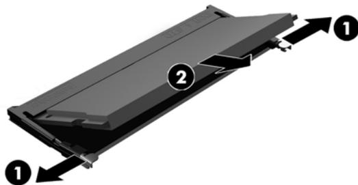
10. Deslize o novo módulo de memória (1) para dentro do soquete num ângulo de aproximadamente 30°, depois pressione o módulo de memória para baixo (2) de forma que as travas se encaixem corretamente.
