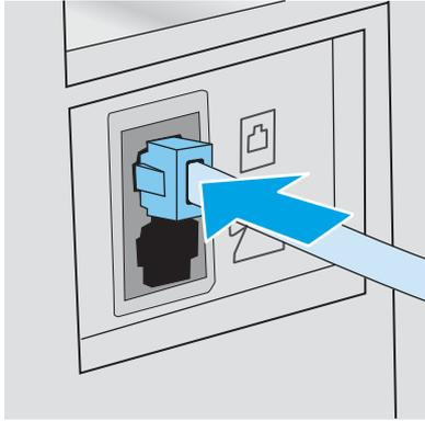
4. 将应答机电话线连接到打印机后部的电话线路输出端口。
