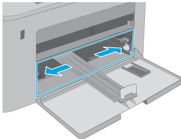
3. 将导板滑到所使用的纸张尺寸位置，以调整纸张长度导板。
