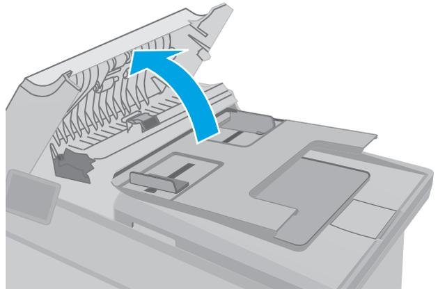
2. 使用蘸水的无绒布擦拭拾纸轮和分隔垫，以消除灰尘。
