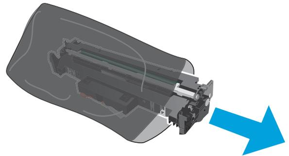
7. 不要接触成像鼓。如果成像鼓上有手印，将影响打印质量。
