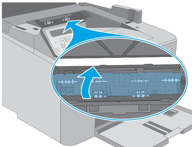
9. 将成像鼓与打印机内的导轨对齐，然后装上成像鼓，直至其牢固就位。
