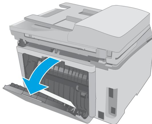
2. 取出双面打印区域中的所有卡纸。使用双手取出卡纸，以免撕破纸张。
