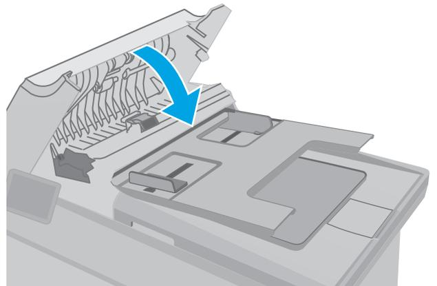
6. 打开扫描仪盖板。如果纸张卡在白色塑料底板后面，请轻轻拉出纸张。
