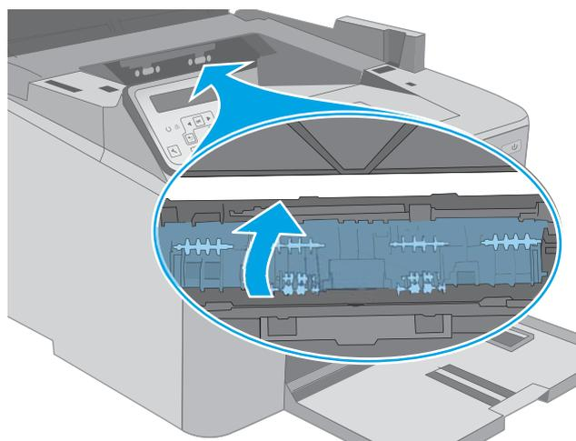
10. 将成像鼓与打印机内的导轨对齐，然后装上成像鼓，直至其牢固就位。
