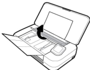
To pruža jednostavan pristup staklu za skeniranje (1) i jastučiću za odvajanje (2).
