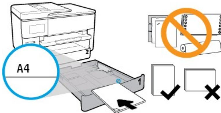
Assicurarsi che la pila di fogli sia allineata alle linee del formato carta appropriato sulla parte anteriore del vassoio. Inoltre, verificare che la pila di fogli non superi il contrassegno dell'altezza della pila sul bordo destro del vassoio.
