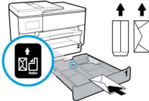
Assicurarsi che la pila di buste sia allineata alle linee del formato carta appropriato sulla parte anteriore del vassoio. Inoltre, verificare che la pila di buste non superi il contrassegno dell'altezza della pila sul bordo destro del vassoio.
