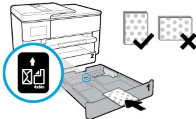
Assicurarsi che la pila di biglietti o carta fotografica sia allineata alle linee del formato carta appropriato sulla parte anteriore del vassoio. Inoltre, verificare che la pila di biglietti o carta fotografica non superi il contrassegno dell'altezza della pila sul bordo destro del vassoio.
