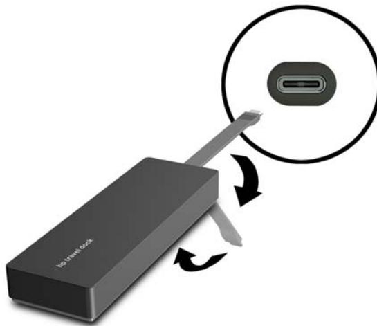
4. Befestigen Sie das Kabel an der Unterseite des Docks.
