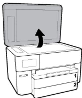
2. 请将原纸张打印面朝下放入，并将其与玻璃板左后角上的标记对齐。
