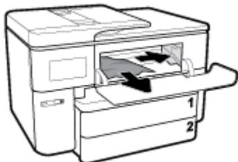
如有必要，请将托架移动到打印机的最左侧，并取出任何卡纸或皱纸。
