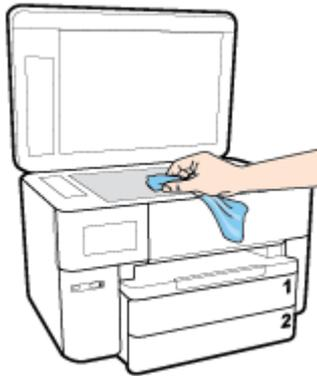
**⚠ 注意：**只能使用玻璃清洁剂清洁扫描仪玻璃板。避免使用包含研磨剂、丙酮、苯和四氯化碳的清洁剂，所有这些物质都会损坏扫描仪玻璃板。避免使用异丙醇，因为它会在扫描仪玻璃板上留下条纹。
