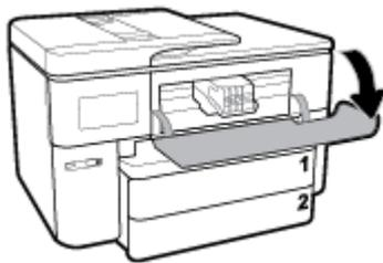
2. 如果墨盒托架未被堵塞，则将墨盒托架移动到打印机的最右侧并取出卡住的纸。
