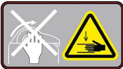
Quetschrisiko. Wenn Sie die Eingabe/Ausgabe des Druckmaterials von der Einlegposition zur Druckposition verschieben, besteht das Risiko, dass Ihre Hand zwischen der Eingabe/Ausgabe für das Druckmaterial und dem Standfuß eingequetscht wird. Stellen Sie sicher, dass niemand in der Nähe des Druckers ist, wenn Sie die Eingabe/Ausgabe für das Druckmaterial verschieben.
