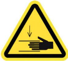
Riesgo de aplastamiento. Tenga cuidado con los dedos al mover la barra de tensión a la posición de estacionamiento: podría pillarse los dedos contra las cubiertas laterales de la entrada/salida del sustrato.
