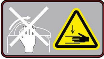
Riesgo de aplastamiento. Cuando mueve la posición de entrada/salida del sustrato de la posición de carga a la posición de impresión, podría aplastarse la mano colocada entre la entrada/salida del sustrato y el soporte. Asegúrese de que nadie está cerca de la impresora cuando desplace la entrada/salida del sustrato.
