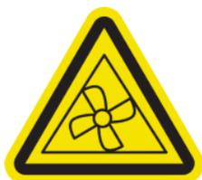
Danger de pièces en mouvement. Rotation des lames de ventilateur. N'y mettez pas vos mains
