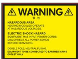
Zone dangereuse. Les modules de chauffage fonctionnent à des tensions dangereuses.
