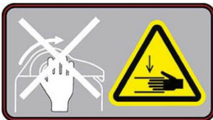
Risco de esmagamento. Quando você move a posição de entrada/saída do substrato da posição de carregamento para a posição de impressão, corre o risco de esmagar sua mão entre a entrada/saída do substrato e o suporte. Certifique-se de que ninguém está perto da impressora quando mover a entrada/saída do substrato.
