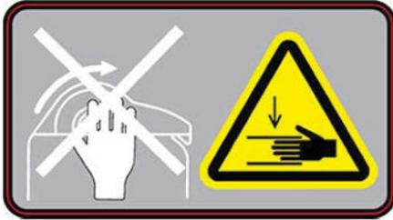
壓傷風險。在您將紙材輸入/輸出位置由裝入位置移動至列印位置時，您的手會有在紙材輸入/輸出與機架之間壓傷的風險。在移動紙材輸入/輸出時，請確定沒有人員靠近印表機。
