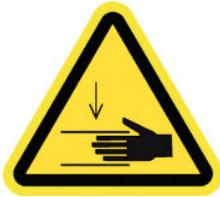
壓傷風險。在將張力桿移動至停放位置時，請小心您的手指：您的手指可能會被紙材輸入/輸出的側護蓋壓傷。
