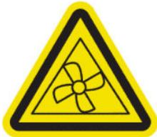
具危險性的移動零件。旋轉式風扇葉片。請保持您雙手與風扇葉片的距離。
