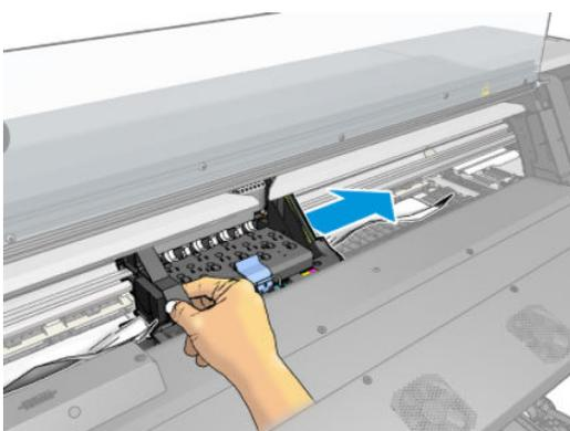
5. 小心地從印表機上方盡可能移除卡住的紙材。在必要時裁切紙材。應提起壓輪，以輕鬆清除卡紙。如果沒有提起，請在上蓋開啟時重新啟動印表機，強制壓輪移動並鬆開紙材。
