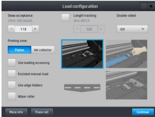
您也可以在前控制面板畫面中的**紙材**方塊向左滑動手指，以啟動手動裝紙。
