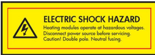
觸電危害。加熱模組以危險的高電壓運作。請在維修之前拔掉所有電源。
