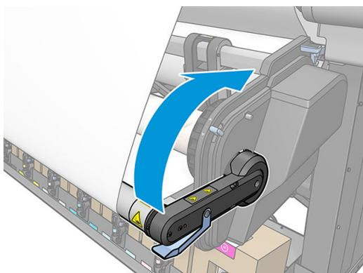
3. 使用捲紙軸馬達上的藍色捲繞手柄，將過剩的紙材捲繞在捲紙軸上。
