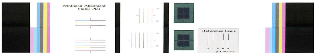
檢查對齊診斷圖件上細診斷條的連續性。在其中一區域中，彩色線條與黑色線條一起列印，以測不同色彩之間的對齊。在另一區中，彩色線條的列印方式是一半向前成像，另一半則反向成像，以測試兩個方向的對齊。在這兩套圖樣中，印字頭未對齊可看於線條中心的一個梯級（以短黑線條標示）。
