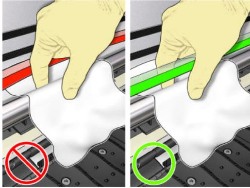
4. 等到托架桿乾了，再關上窗蓋。托架會移至印表機的左邊，好讓您可以接觸右邊護蓋下的托架桿部分。
