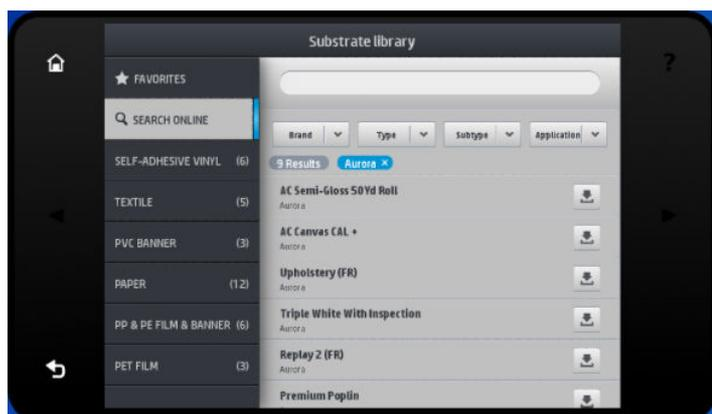
一旦任何紙材預設檔已在背景中下載，它會被檢查並安裝在印表機的硬碟中。在檢查並安裝時，全螢幕訊息會顯示在前端面板上。檢查與安裝完成時，此訊息就會消失。
