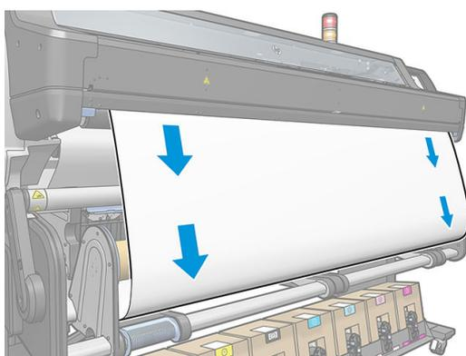
8. 移動捲紙軸馬達上的藍色手柄，將紙軸旋轉一周。這將有助於支援張力桿的重量。將紙軸往適當的方向旋轉，以朝內或朝外列印影像。
