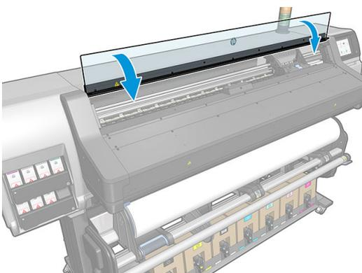
10. 前控制面板螢幕會確認所有列印噴頭都已正確地插入。印表機會開始檢查並準備印字頭。如果更換所有的印字頭，則預設的例行性程序最多需要 18 分鐘才能完成。如果印表機在準備列印噴頭的過程中發現問題，則可能需要更長的時間，最多需要 30 分鐘。如果只插入單一系列印噴頭，則需要 10 到 20 分鐘。檢查並備妥所有印字頭之後，如果已裝入紙材，將會自動執行重新校正印字頭的程序。
