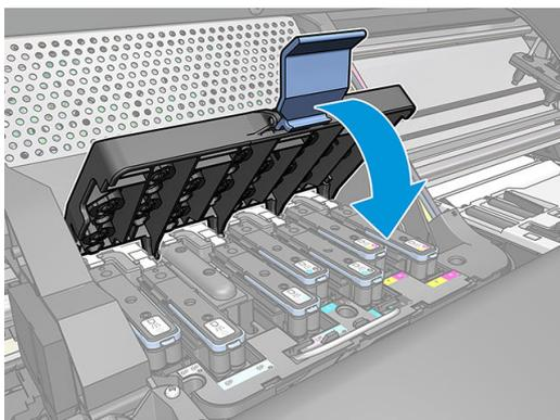
7. 確定門鎖的末端已卡住托架內側的電線迴圈。
