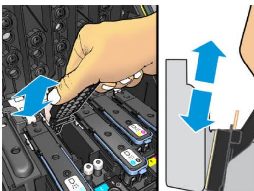
9. 除非是全新的印字頭，否則請使用相同海棉來清潔印字頭之電氣接觸面的下方長條。請避免碰觸上方的那組電氣接觸面。
