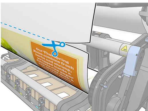
5. 手持紙材，使用捲紙軸馬達上的捲繞按鈕，繞著捲紙軸，捲繞多出的紙材。
