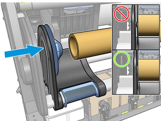
3. 前移紙材，直到抵達捲紙軸軸心。確定張力桿位於收回位置。
