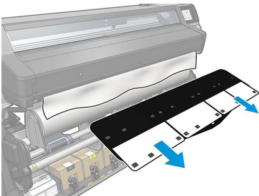
9. 當裝入多孔紙或薄紙材，且已核取「裝入附件」選項時，印表機不會檢查歪斜現象。依照[位於第 70 頁的將捲筒裝在捲紙軸上](#)中的指示將歪斜現象最小化。
