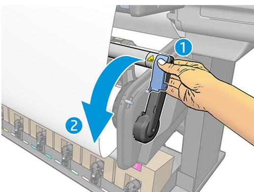
12. 下圖顯示印表機作業時的外觀。紙材從印表機送入時，會先下落到張力桿，然後再下落到捲紙軸。
