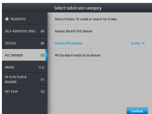
每一個一般預設檔都是一整個紙材類型設計，而非特定紙材類型。它們無法編輯、清除、儲存、色彩校準或建立 ICC 設定檔；但可以仿製 (clone)。因此如果您想以任何方式修改一般預設檔，應該先仿製此檔，然後以可以編輯的仿製檔工作。
