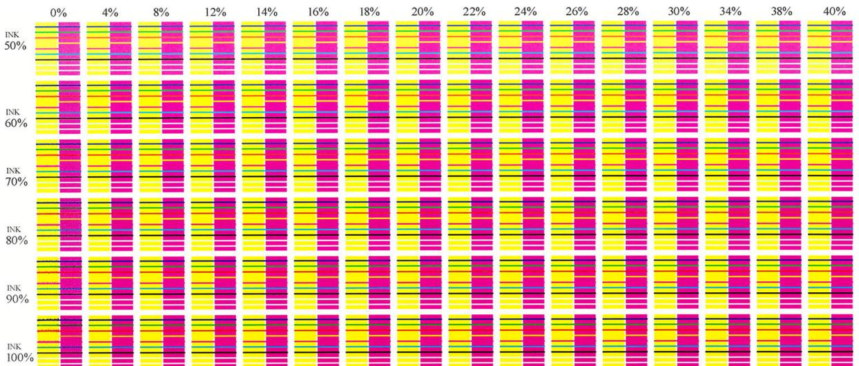
此圖表可協助您調整使用優化劑。某些紙材需要較多或較少的優化劑，視其塗層、墨水量，以及成像次數而定。每個捲筒紙可能會有不同。您可以使用各種列印模式列印這張圖表，檢查哪個圖樣看起來最佳。
