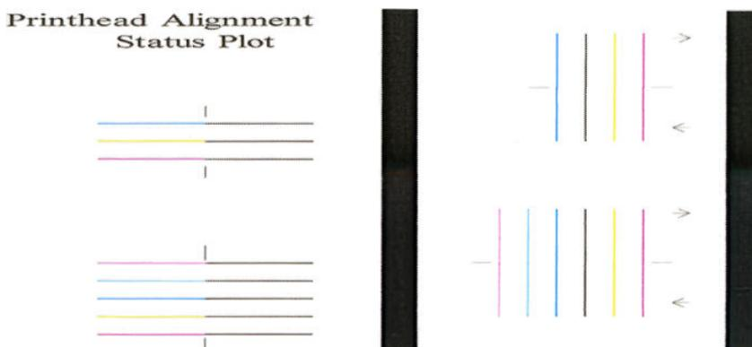
請記得，些微的未對齊可能不會造成任何列印品質上的瑕疵。列印程序的設計可以隱藏少量的未對齊效果。參考刻度可用來量化未對齊的量；低於 4/600 英吋的英吋不太可能會造成列印品質瑕疵。
