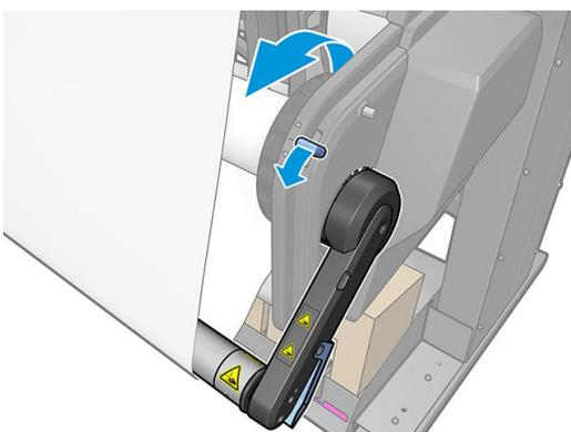
11. 輕輕降低張力桿，從固定位置解除鎖定。
