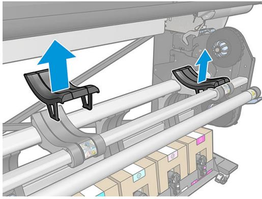
2. 若捲筒的核心直徑為 2 英吋，請安裝 2 英吋的輪轂套件。
