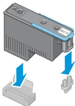
3. 印字頭的設計可使您避免不小心將印字頭插入錯誤的插槽。請檢查印字頭上的顏色標籤是否符合印字頭要插入之墨水匣的顏色標籤。
