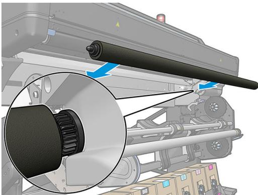
3. 印表機會偵測正在使用清潔滾筒，並在「紙材」與「裝入」畫面中將其顯示為可用。它也會顯示已使用清潔滾筒列印的紙材長度。
