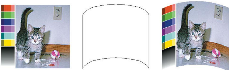
您可以彌補這種作用，並還原您影像的原始形狀：在您的 RIP 或紙材庫中，選取 -6 至 +6 的修正值。要在 RIP 中套用校正，請參閱您的 RIP 說明文件。
