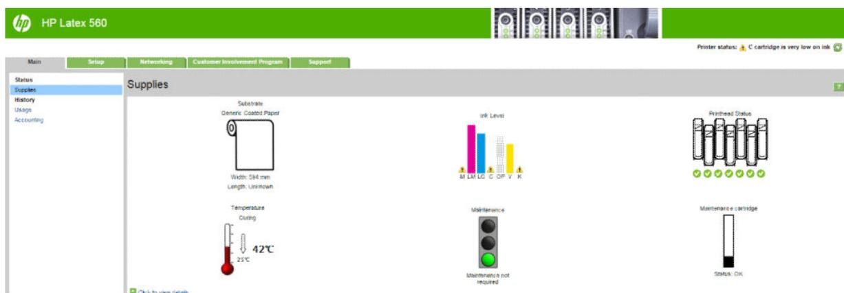
「耗材」頁面會顯示裝入的紙材、墨水匣、印字頭、加熱器與維護墨水匣的狀態。
