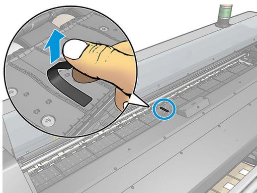
3. 以相同方式移除平台的兩個零件。
