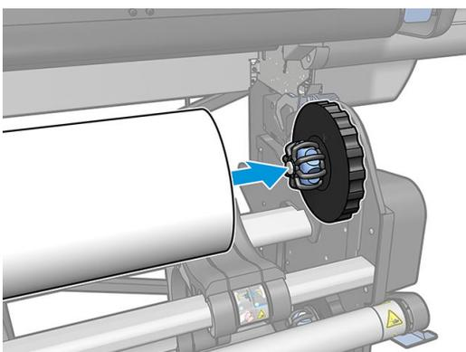
5. 提起左手側的捲筒紙，然後裝入左側輪轂。施以壓力，確定已緊密裝入。
