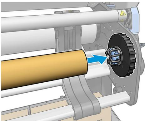
2. 將左側輪轂裝入軸心。從側面施以壓力，確定已緊密裝入。
