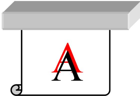
如果任何方向的色彩都未對齊，則印字頭可能沒有對齊。如果您長時間未校正印字頭，或者發生卡紙時，就可能發生這種情況。請依需要校正印字頭（請參閱「[位於第 138 頁的校正印字頭](#)」）。您可以使用印字頭狀態圖件來檢查是否需要進行此動作（請參閱[位於第 109 頁的 3. 印字頭校正狀態圖](#)）。
