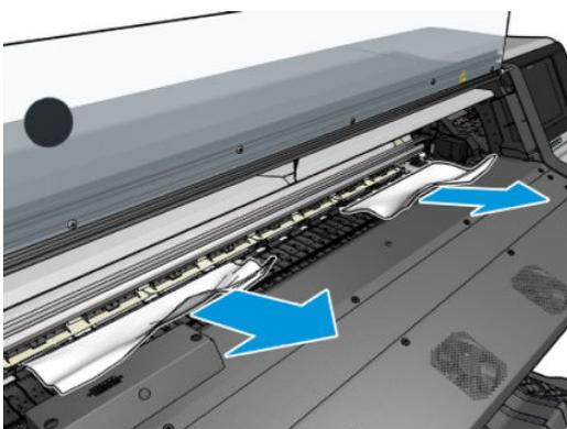
**⚠ 注意：** 盡量避免穿越進紙路徑拉出紙材，因為這會倒轉一般的移動方向，可能損壞印表機零件。
