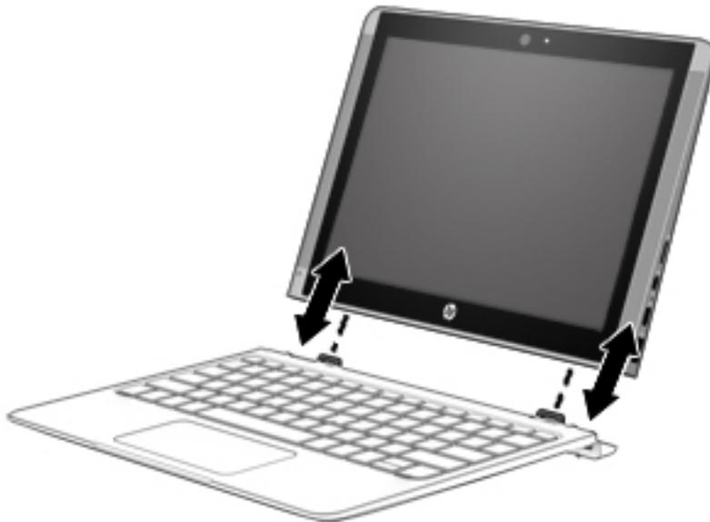
**PRECAUCIÓN:** Si su teclado contiene una unidad de disco duro, desconecte la unidad antes de extraer el teclado. Si no se desconecta el teclado antes de su extracción, la unidad de disco duro y los archivos de datos podrían dañarse.
