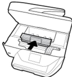
4. Если проблема осталась, проверьте пространство вокруг каретки внутри принтера.
