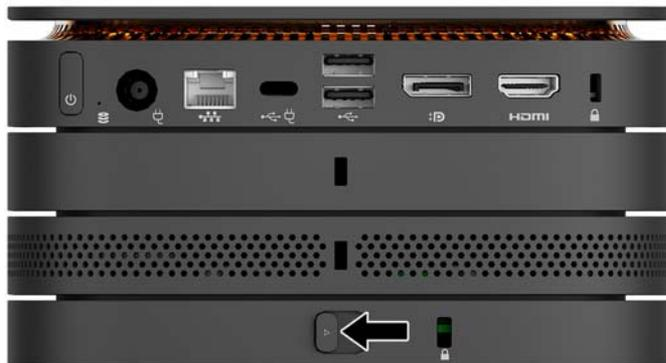
**NOTA:** HP consiglia vivamente di fissare il gruppo Elite Slice collegando un cavo di sicurezza sul retro della piastra VESA. Questo consente di bloccare lo spostamento della levetta di rilascio rapido dalla posizione di sblocco e quindi impedire il rilascio accidentale dei moduli.
