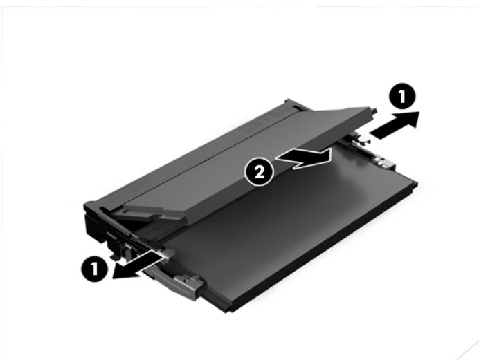
3. Inserire il nuovo modulo di memoria nello slot con un'angolazione di circa 30° (1), quindi premerlo nello slot (2) in modo che le levette lo blocchino in posizione.
