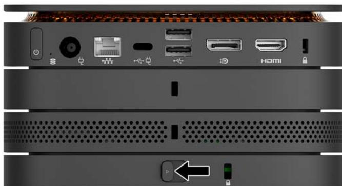
10. Installare un cavo di sicurezza nell'attacco per cavo di sicurezza della piastra VESA per impedire che la levetta di rilascio rapido si sblocchi e i moduli si separino.
