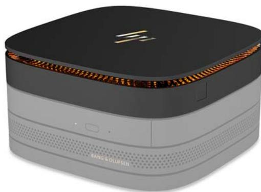
Il dispositivo Elite Slice è il modulo di base, il modulo essenziale unico. È dotato di un lettore di impronte digitali complete opzionale: anziché passare il dito sul lettore, è necessario premervi il dito sopra. Questo lettore è più accurato rispetto ai lettori a scorrimento.
